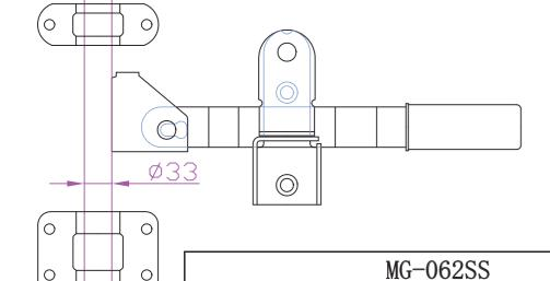
代号 组件名 规格型号 单位 数量 材料 铰链 不锈钢 锅钩&锅钩座 MG-B016SS В MG-D010SS 长导套&导座 不锈钢 (含嵌入塑料导套) MG-C011SS 短导套&导座 不锈钢 D (含嵌入塑料导套) Е 锁具组件 MG-E013SS 不锈钢 挂钩&挂钩座 0 〈外径33mm 选件
